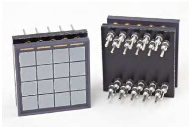
Figura 3.4 Ilustración de la matriz 4 x 4 del SiPM SensL.
